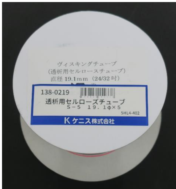
透析用セルローズ チューブ (19.1 mm \phi × 5 m)
